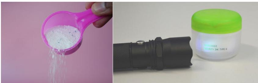
La tinta UV puede utilizarse como elemento de seguridad para añadir marcas o códigos ocultos destinados a certificar la autenticidad de un producto. Sin embargo, el colorante que se hace visible cuando se aplica luz ultravioleta es más común de lo que pensamos, dado que es uno de los ingredientes principales de la mayoría de los detergentes que usamos para la ropa. Y es que el tono azulado de este colorante ayuda a contrarrestar el
